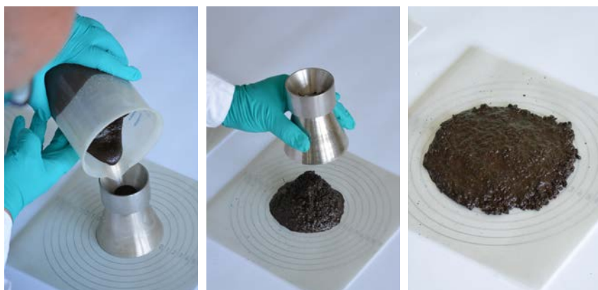
Figure 2 – Essai de consistance selon la NBN EN 12274-3
