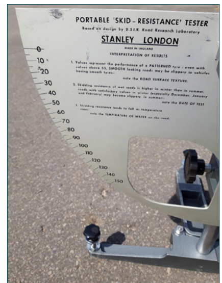
Figuur 4 – Arbitraire schaal van de SRT-slinger (Pendulum Test Value, PTV)
