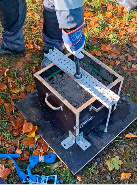
Figuur 1 - Box Test: Evaluatie van de geschiktheid voor plaatsing met glijbekisting van wegebeton © OCW
