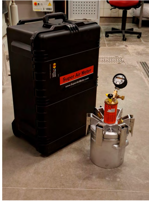
Figuur 2 - Super Air Meter: Meting van het luchtgehalte en de kwaliteit van het luchtbelnetwerk in vers beton © OCW
