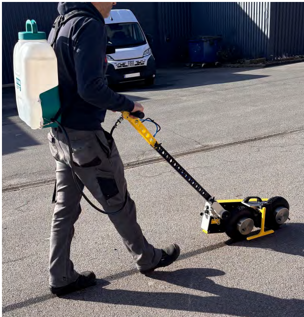
Figuur 2 – T2GO Friction Tester, een continue meetmethode © OCW
