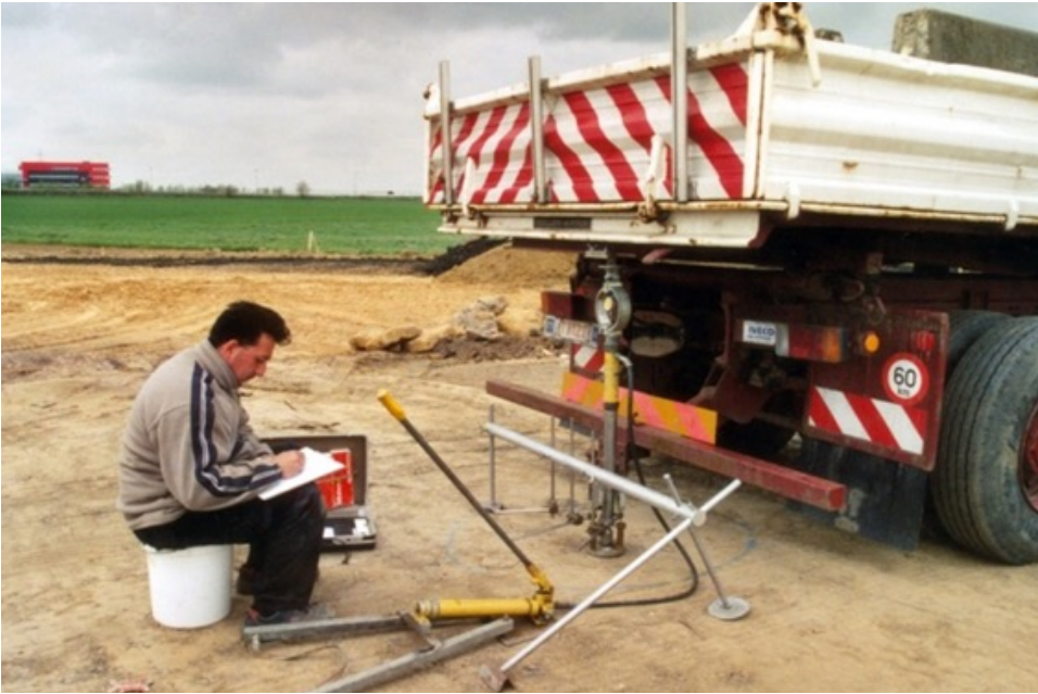
Figures 1 et 2 – Essais à la plaque statique (à gauche) et dynamique (à droite) © CRR
