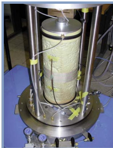
Figuur 3 – Proefstuk dat met meetinstrumenten is uitgerust
