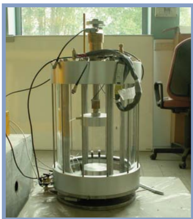
Figuur 1 – Apparatuur voor de cyclische triaxiaalproef in het OCW
