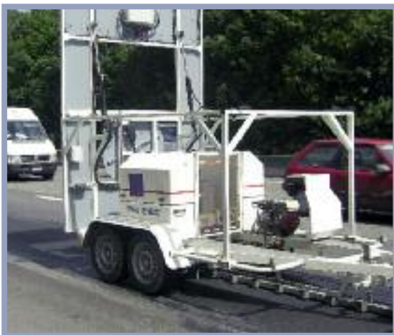
Valgewichtdeflectiometer van het OCW
