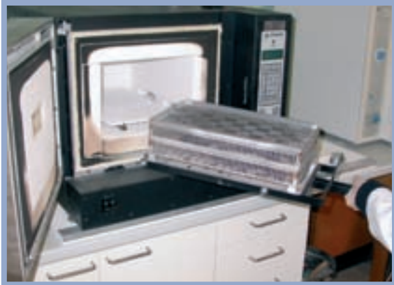
Figuur 2 - Manden met asfaltmonster worden in de ontbrandingskamer geschoven
