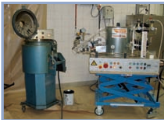
Figuur 2 - Schuimeenheid van Nynas (rechts) en laboratoriummenger (links)
