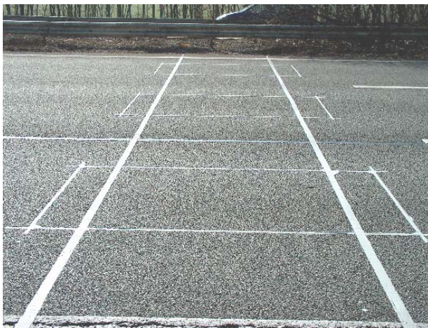
Boucles et barreaux piézo-céramiques (photo CRR)
