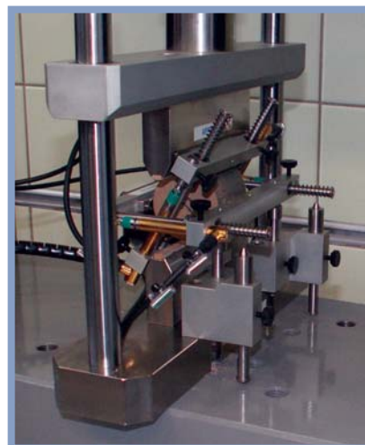
Figure 2 – Dispositif pour la détermination du module E_{it} et du coefficient de Poisson \nu
