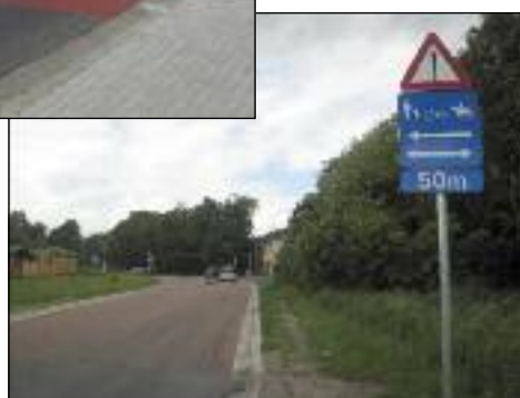
Signal de danger avec additionnel «traversée usagers faibles» sur la voirie motorisée
