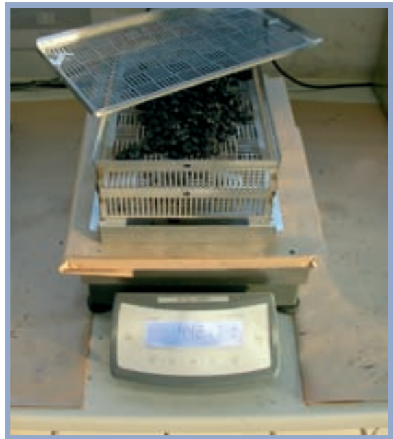
Figure 1 - Panier d'analyse contenant l'enrobé bitumineux
