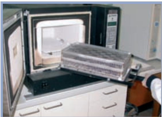
Figure 2 - Opération d'enfournement dans la chambre du four
