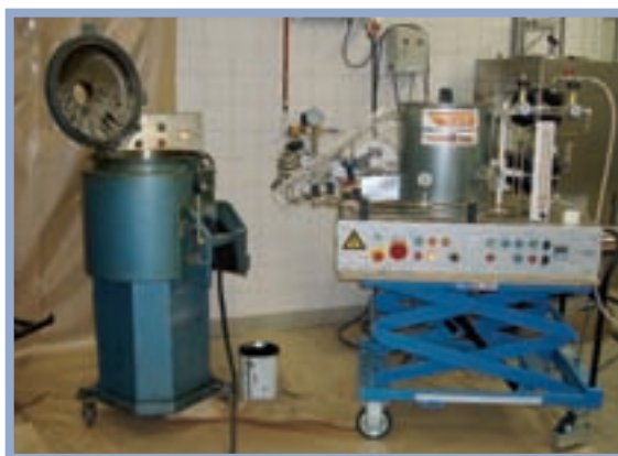
Figure 2 - Générateur de mousse de Nynas (à droite) et malaxeur de laboratoire (à gauche)
