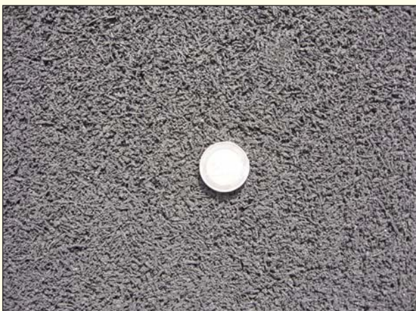
Revêtement «poroélastique» expérimental de confection japonaise, posé en tapis de 1 x 1 m (section expérimentale DUWU à Kloosterzande, Zélande, Pays-Bas)
